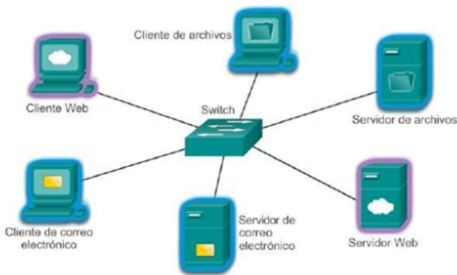
Una computadora con software de servidor puede prestar servicios a uno o varios clientes simultáneamente.
