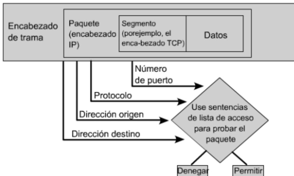
Las ACL filtran el tráfico de red, controlando si los paquetes enrutados se envían o se bloquean en las interfaces del router. El router examina cada paquete y lo enviará o lo descartará, según las condiciones especificadas en la ACL. Algunos de los puntos de decisión de ACL son direcciones origen y destino, protocolos y números de puerto de capa superior.
