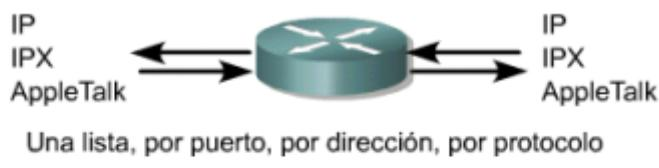
Con dos interfaces y tres protocolos ejecutándose, este router puede tener una cantidad total de 12 ACL distintas aplicadas.
