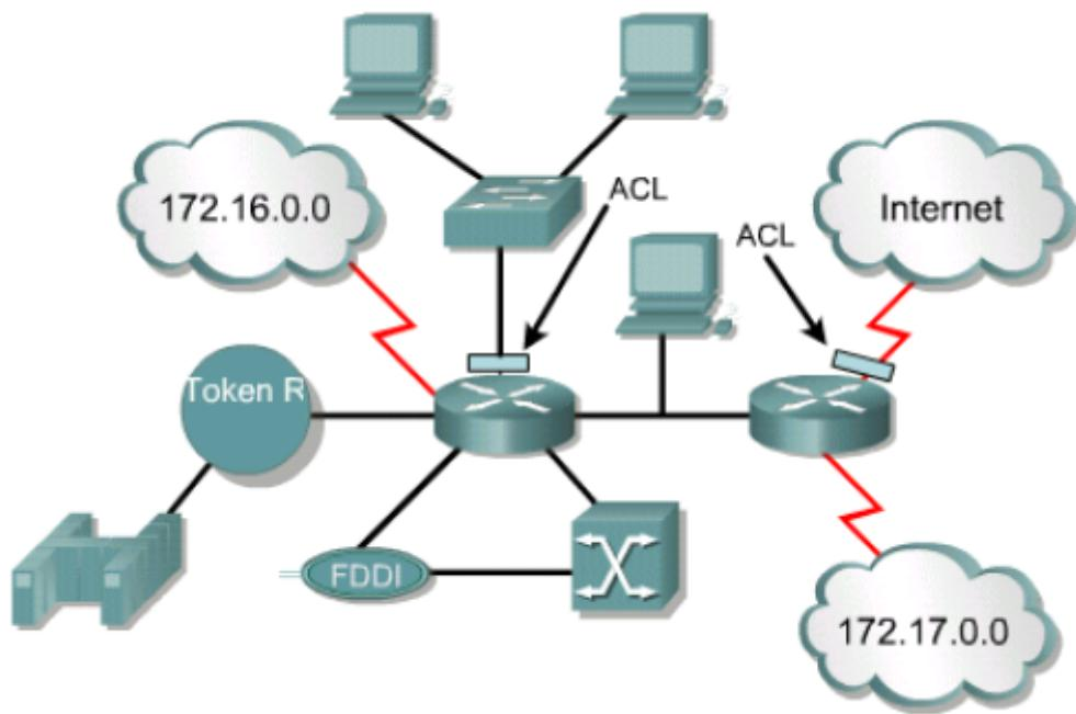
Es posible crear ACL en todos los protocolos de red enrutados, por ejemplo: el Protocolo de Internet (IP) y el Intercambio de paquetes de internetwork (IPX: protocolo utilizado por las redes Novell Netware). Las ACL se pueden configurar en el router para controlar el acceso a una red o subred.
